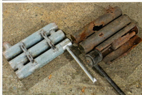
Eigeninitiative gefragt: Mit der Hilfe eines erfahrenen Schweißers aus der Nachbarschaft entstand ein neuer Auspuff
