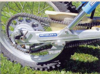
Leichte Stahl-schwinge mit Sachs Hydrocross-Federbeinen
