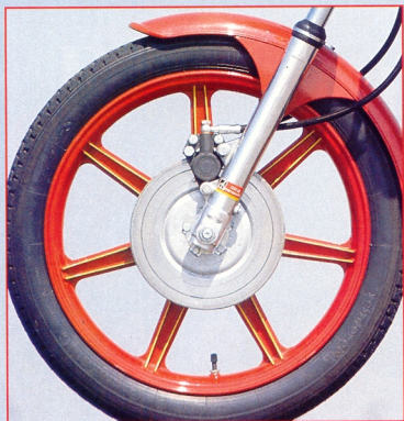
Fast wie eine 500er Rennmaschine: Doppelscheibenbremse und Gussräder kamen von Grimeca
