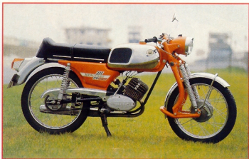
Tiefstapler: Ab 1970 kam der Fächerkopf-Motor mit offiziell 6,25 PS zum Einsatz. Das reichte, um die K 50 SE an der 90-km/h-Marke kratzen zu lassen
