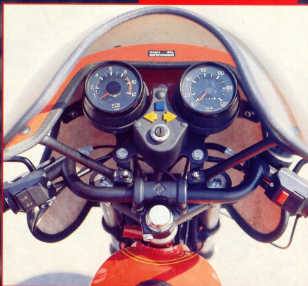
Schwarzer M-Lenker und VDO-Wasseruhren: „schnelles“ Zubehör schon ab Werk
