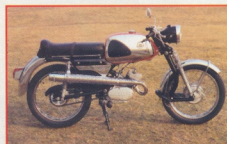
Beachtlich an der K 50 RL ist die große Bremse, ins Auge fällt eher der hoch gelegte Auspuff
