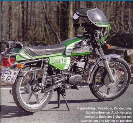
Weiterhin 6,25 PS, aber viel leiser: Die schon bei der Ultra I eingeführte Wasserkühlung senkte den Geräuschpegel deutlich
