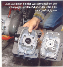
Weil der Motor in viele verschiedene Rahmen passen musste, setzte Hercules auf einen kleinen Kühler direkt am Zylinder
