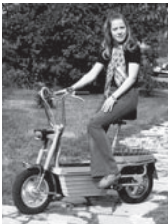
War schon 1974 ein Thema: Accu-bike mit zwei 12-Volt-Bleibatterien. Reichweite im Winter: 7 Kilometer.
